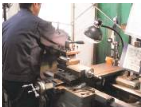
▲熟練の技を活かした汎用旋盤による金型の切削作業
